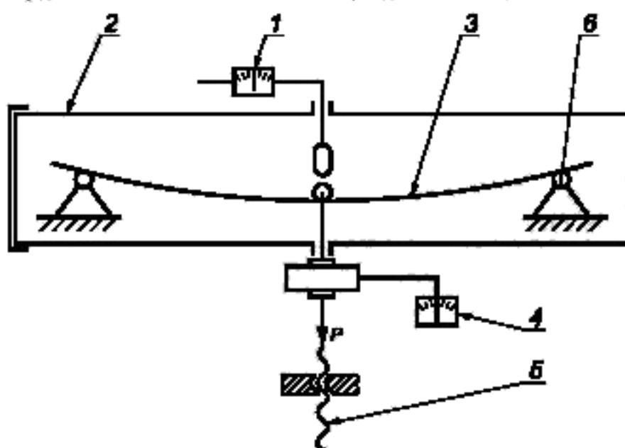
1 — датчик измерения температуры; 2 — нагревательная камера; 3 — образец; 4 — датчик измерения силы;
