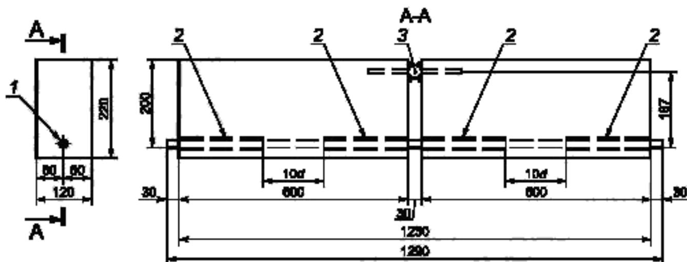
1 — стержень, 2 — поливинилхлоридный вкладыш или трубка; 3 — стальной цилиндр
