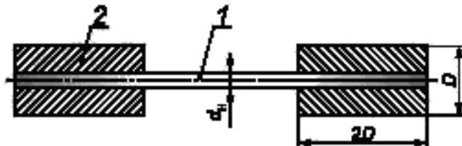
1 — отрезок стержня; 2 — испытательная муфта
