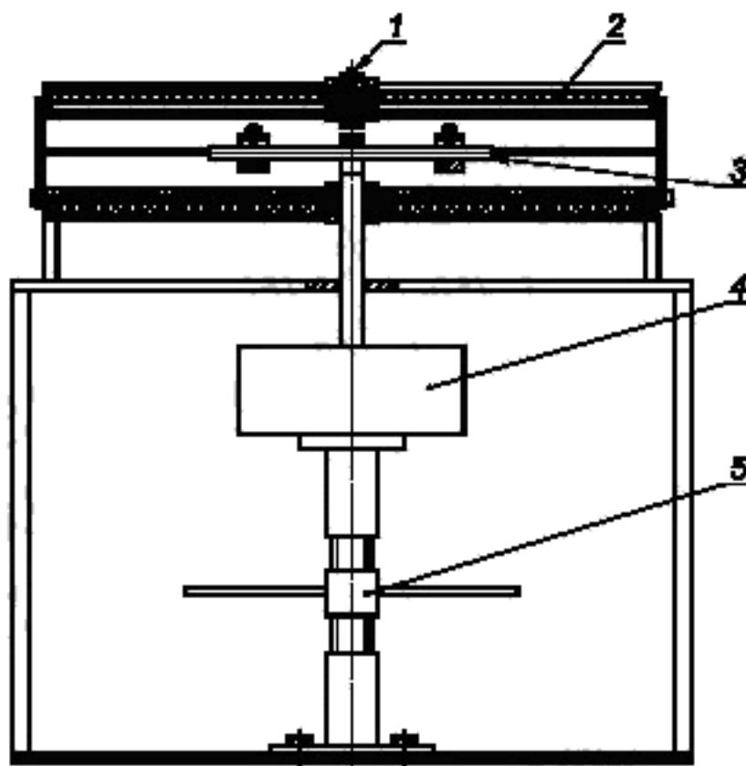
1 — датчик измерения температуры; 2 — нагревательная камера; 3 — образец; 4 — датчик измерения силы;
